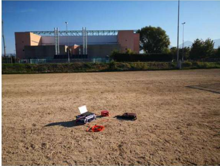
Foto n.5 : stazione sismica di tipo H.V.S.R.
