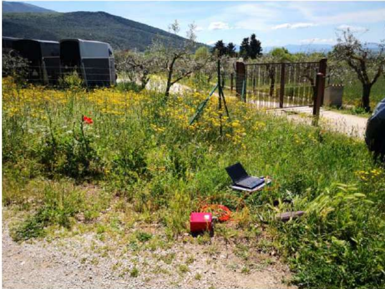
Foto n.2 : stazione sismica di tipo H.V.S.R.
