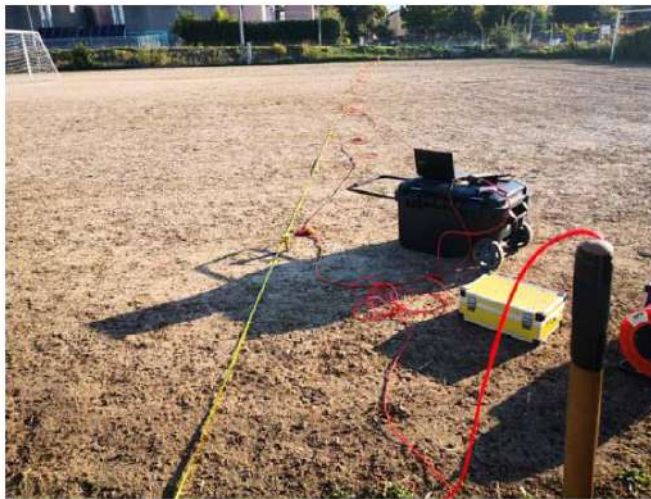
Foto n.1 : stendimento sismico di tipo RIFRAZIONE – TOMOGRAFIA N.1
