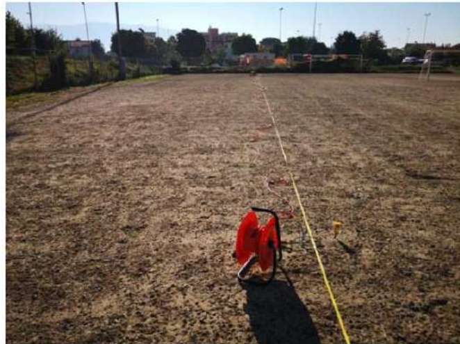
Foto n.2 : stendimento sismico di tipo RIFRAZIONE – TOMOGRAFIA N.2
