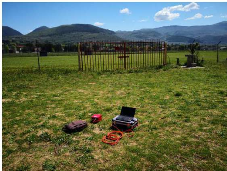
Foto n.2 : stazione sismica di tipo H.V.S.R.
