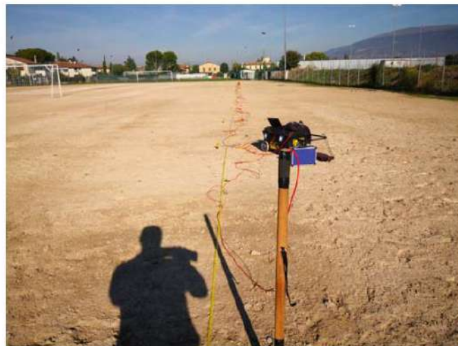
Foto n.4 : stendimento sismico di tipo M.A.S.W. n.2
