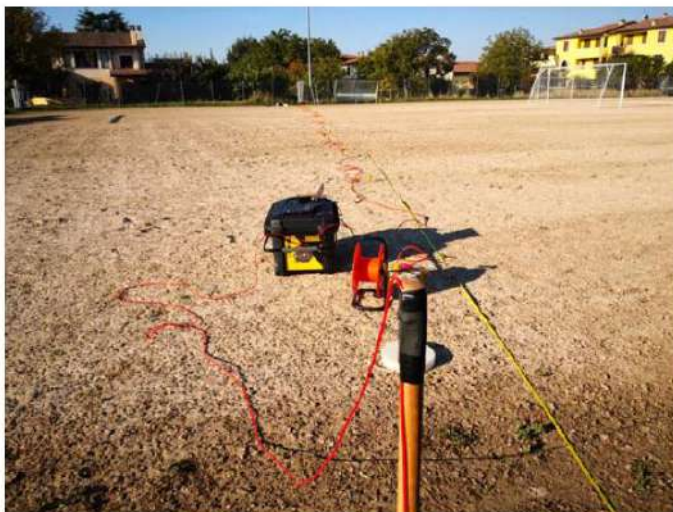
Foto n.3 : stendimento sismico di tipo M.A.S.W. n.1
