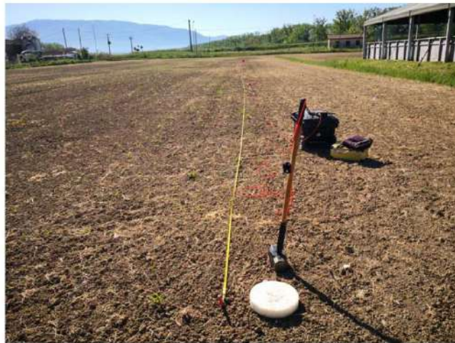
Foto n.1 : stendimento sismico di tipo M.A.S.W.
