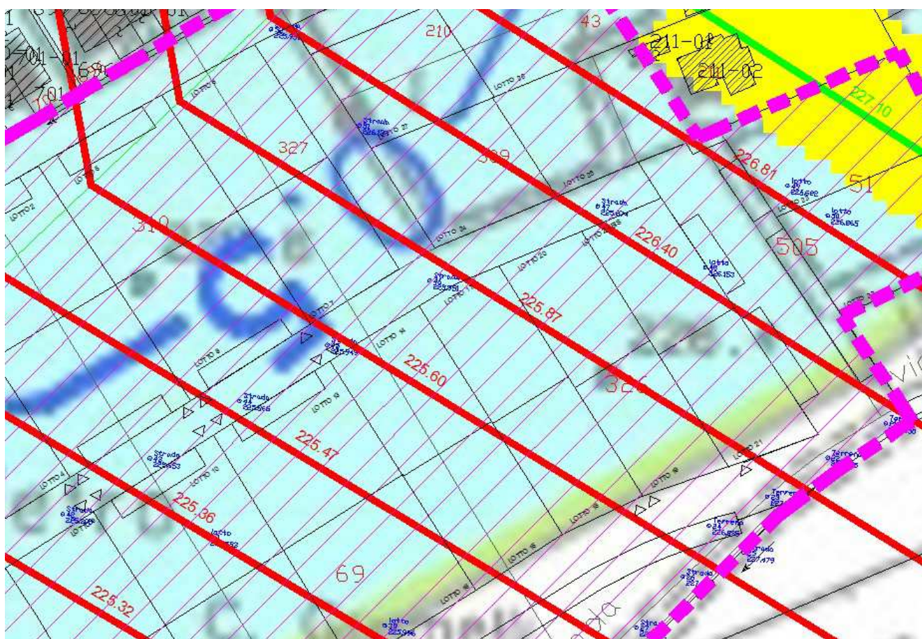
Fig. 7.22 – Planimetria generale della lottizzazione sovrapposta alla Carta delle Fasce fluviali e dell'indicazione delle sezioni di deflusso extra-alveo, con indicazione della quota di sicurezza idraulica – Zoom 1 –
